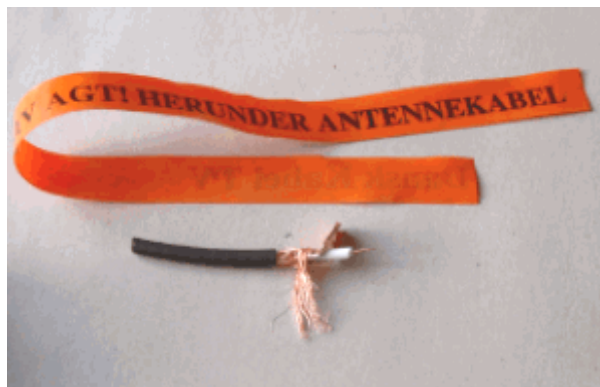
Stikledning og dækbånd. - Bemærk den dobbelte skærm.
